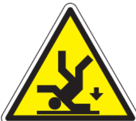
Pericolo di caduta dall'alto
